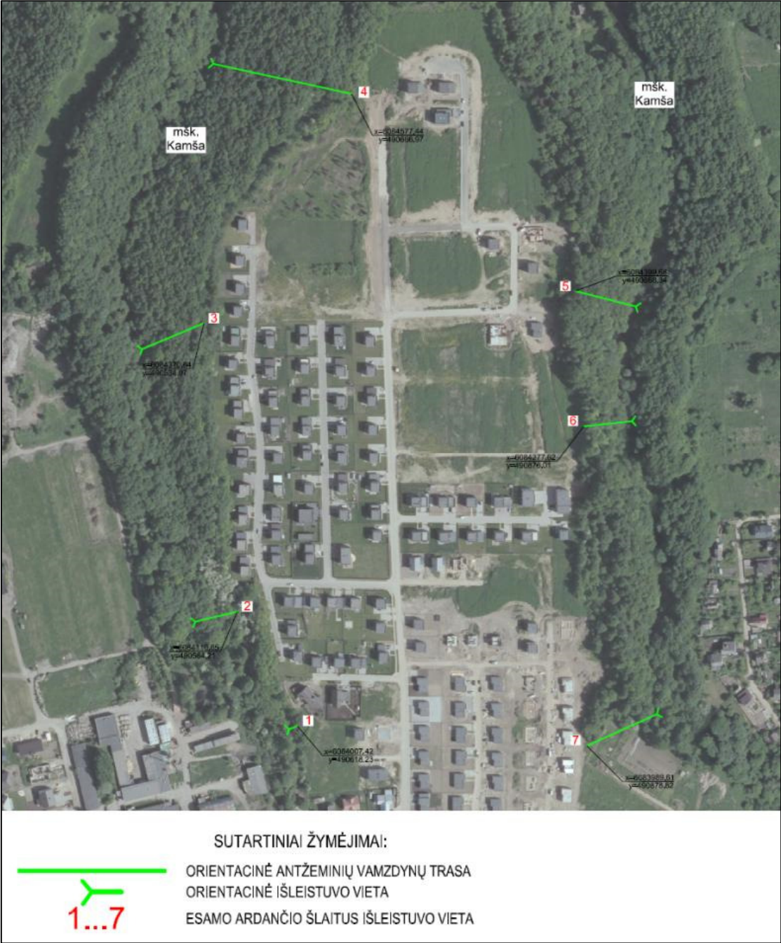
6 pav. Šlaitus ardančių paviršinių (lietaus) nuotekų surinkimo ir nuvedimo laikinų priemonių planas Kamštos botaniniame – zoologiniame draustinyje
