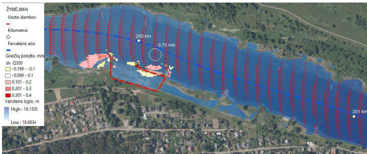
3.16 pav. Tėkmės greičių pokyčiai dėl projektuojamo uosto statinių poveikio esant 350 \text{ m}^3/\text{s} debitui
